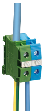
Преобразование схемы TN-C в TN-S Разделение PEN-проводника сечением 10 мм 2 371 98 + 371 04 + 375 42
